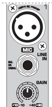
Fig. 2.1: Conexiones y reguladores de las entradas mic/line
