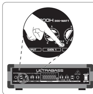
**7** 调节 GAIN 2, SHAPE 和 LEVEL 旋钮，改变通道 2 的音色。
