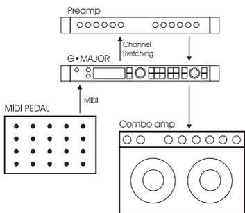
Utilizzando il ritorno nell'Effect Loop del Combo è possibile ottenere un setup simile al Power Amp setup descritto sopra. Utilizzando il normale Input del Combo otterrai un "Double-Preamp" setup, dove potrai utilizzare i controlli di tono del Combo per modificare il tuo suono. Contrariamente al collegamento Effect Return, in questo modo verrà generato maggior rumore, ma si tratta di un setup molto popolare grazie ad amplificatori come il Vox AC 30, il Fender Bassman ecc.
