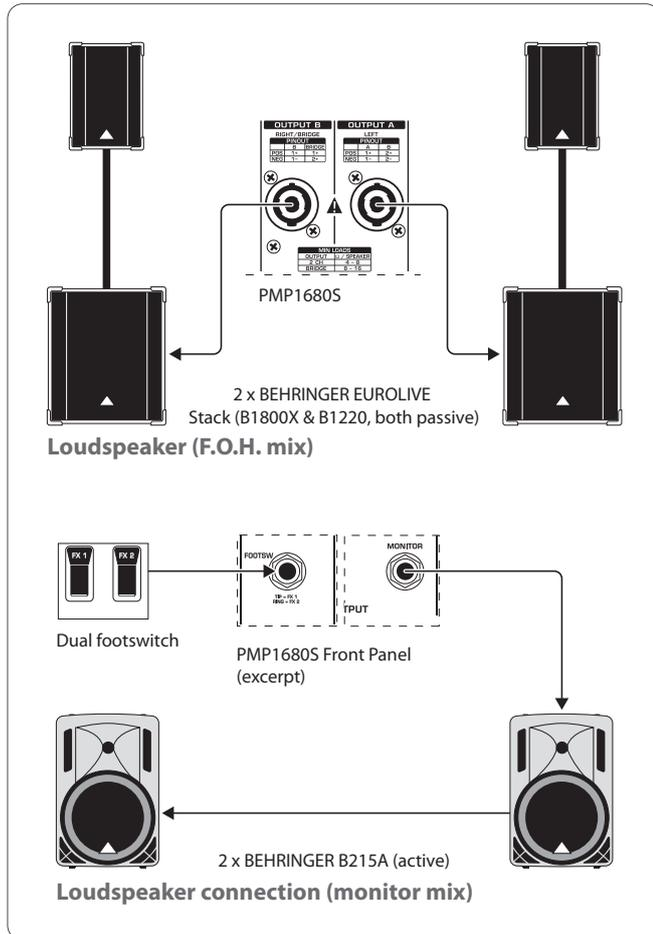
図 5.1: ステレオアンプとしての EUROPOWER (例)
