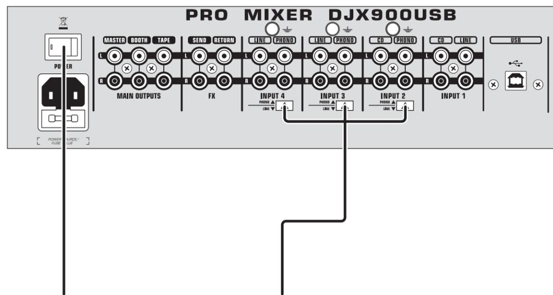
**POWER** スイッチで、ミキサー電源のオン / オフを切り替えます。
