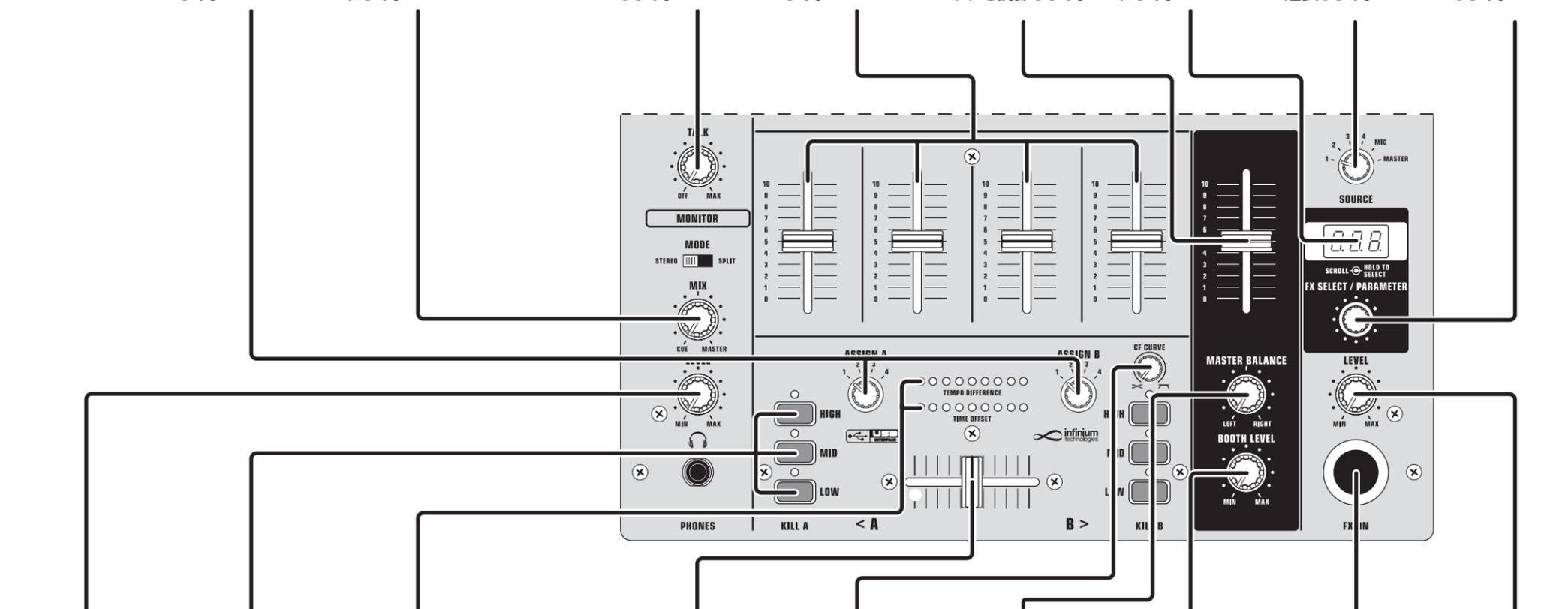
**MONITOR LEVEL** ノブで、ヘッドフォンのボリュームを調節します。
