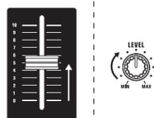
**5** 信号を入力している各チャンネルの GAIN ノブを上げると、CHANNEL VU メーターの LED が光ります。赤いクリップ LED が点灯する場合は、GAIN ノブを下げてください。
