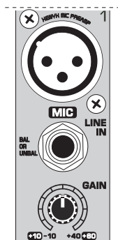
图 2.1: Mic/Line 输入端的接口和调节器
