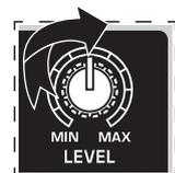
**10** 各スピーカーの MAIN LEVEL ノブを 50% にします (複数のスピーカーを使用している場合は、各スピーカーで MAIN LEVEL ノブを個別に調節する必要があります)。
