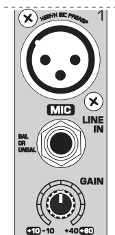
Fig. 2.1: Connettori e manopole degli ingressi Mic/Line
