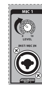
**11** 如果你插入乐器到 MIC 1 或 MIC 2 通道, 弹奏乐器并顺时针缓慢旋转相应通道的 LEVEL 旋钮直到调到合适的电平。
