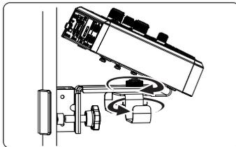
直接安装到麦克风架上对于具有 5/8" 螺纹的美国标准麦克风架:
