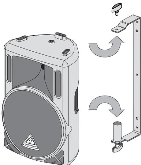
図 1: スピーカーをブラケットへ取り付ける
