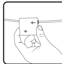
5. 如图所示, 通过压下夹子插座松开电缆。
