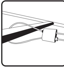
3. 将电缆绕在悬挂点上, 然后进入夹子的另一侧。对二级安全附件重复 1-3。
