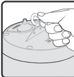
6. 将悬挂电缆连接到扬声器支架的中心孔。安全缆绳可以连接到任何一个辅助孔。
