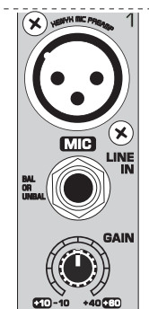
Bild 2.1: Anslutningar och kontroller för mic-/ line-ingångarna
