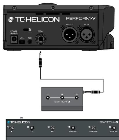
*Anschließen eines Switch-3 oder Switch-6 an den Pedaleingang des Perform-V*
