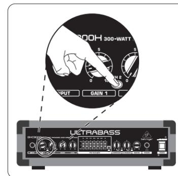
**7** GAIN 2、SHAPE、LEVEL ノブを回してチャンネル 2 のトーンを調節します。
