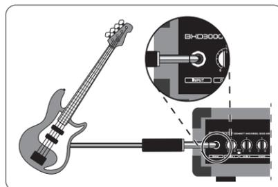
**3** GAIN 1 と LEVEL を絞りきります。MASTER を 9 時のポジションへセットします。
