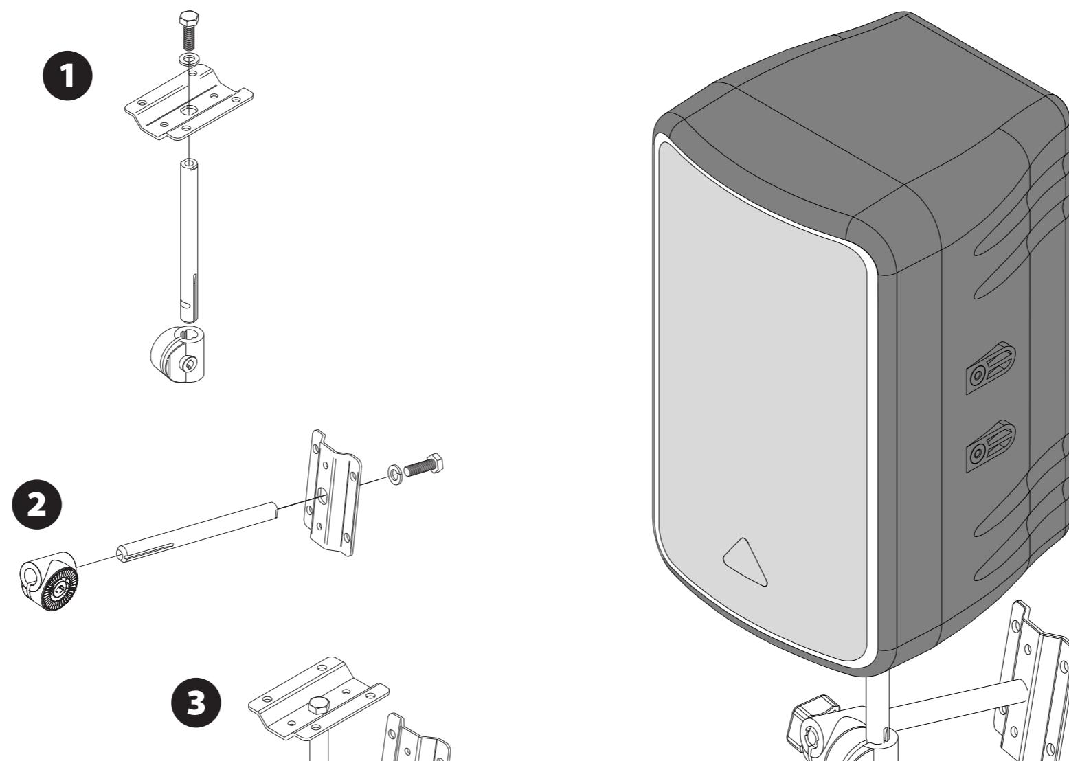
**1** 将一根支撑杆插入音箱连接支架的支撑座上。将配套螺丝穿过音箱安装片, 然后将其拧紧。
