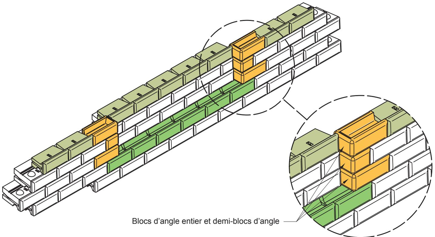
Blocs d'angle entier et demi-blocs d'angle
