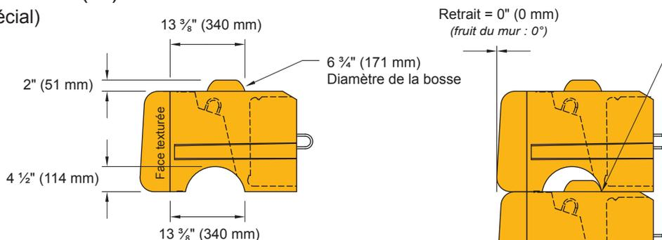
Déplacez les blocs vers l'avant au cours de l'installation pour enclencher les bosses de cisailment (typique)
