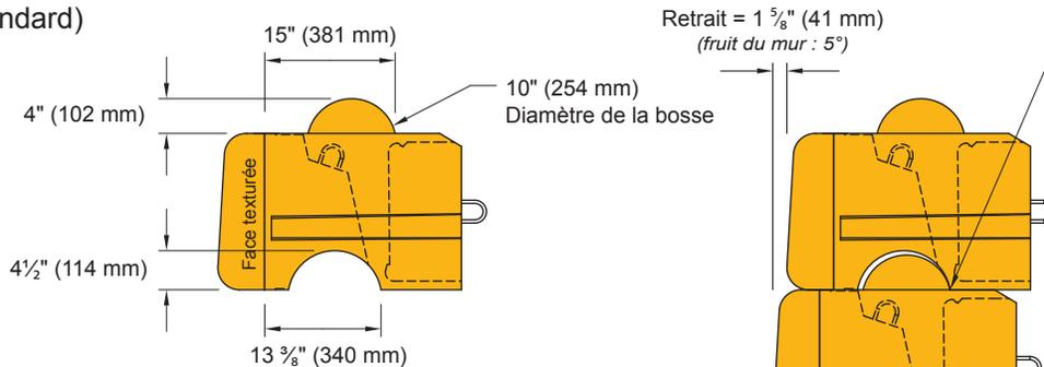
Déplacez les blocs vers l'avant au cours de l'installation pour enclencher les bosses de cisailment (typique)
