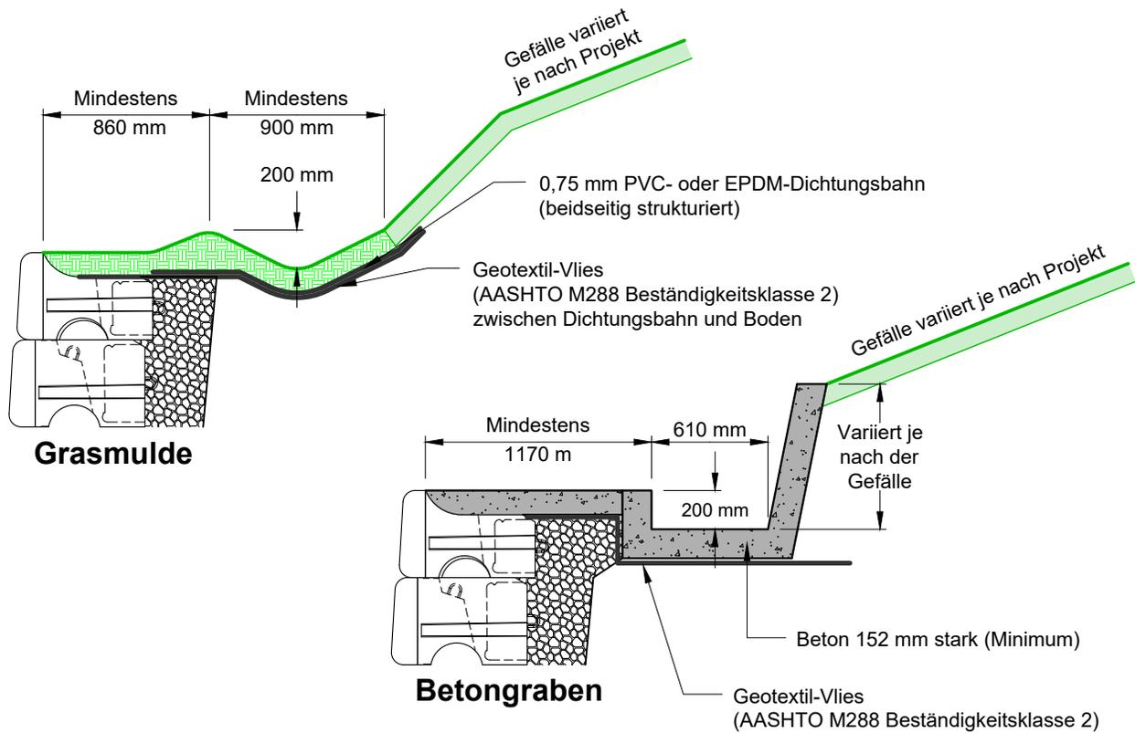
Neigen Sie das Quergefälle des Grabens so, dass ein Gefälle von (mindestens) 1 bis 2% parallel zur Wand entsteht
