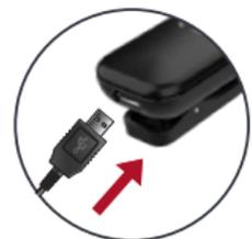
Branchez l'extrémité USB du câble de chargement dans une prise USB femelle sur l'adaptateur d'alimentation fourni.
