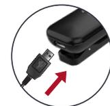
Conecte el extremo USB del cable de carga a un conector USB hembra en el adaptador de corriente incluido.
