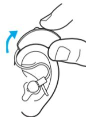
2. Pressione a oliva ou molde auricular em seu canal auditivo até ficar seguro. (Para moldes auriculares, pressione suavemente com a ponta do dedo). O cabo deve ficar encostado na sua cabeça.
