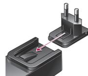
3. Per rimuovere la presa, premere la linguetta e fare scivolare via la presa dall'adattatore.
