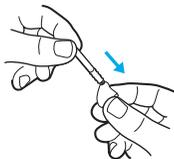
2. Ziehen Sie den Applikationsstick gerade heraus, um den benutzten Cerumenschutzfilter zu entfernen. Nicht drehen.
