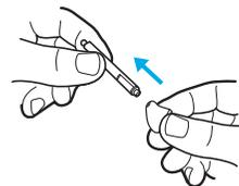
3. Verwenden Sie das entgegengesetzte Ende des Sticks, um einen neuen Cerumenschutzfilter gerade in das Hörsystem einzuführen. Fest drücken.
