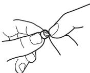
4. Setzen Sie die Batterie so ein, dass die „+“-Markierung nach oben zeigt.
