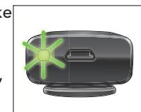
4. Bármely 900 MHz technológiájú, vezeték nélküli hallókészülékről legyen is szó, a szinkronizálást követően automatikusan elkezdődik a hangok átjátszása. Amíg tart az átjátszás, a LED lámpa lassan kéken villog.
