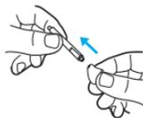
3. Verwenden Sie das entgegengesetzte Ende des Sticks, um einen neuen Cerumenschutzfilter gerade in das Hörsystem einzuführen. Fest drücken.
