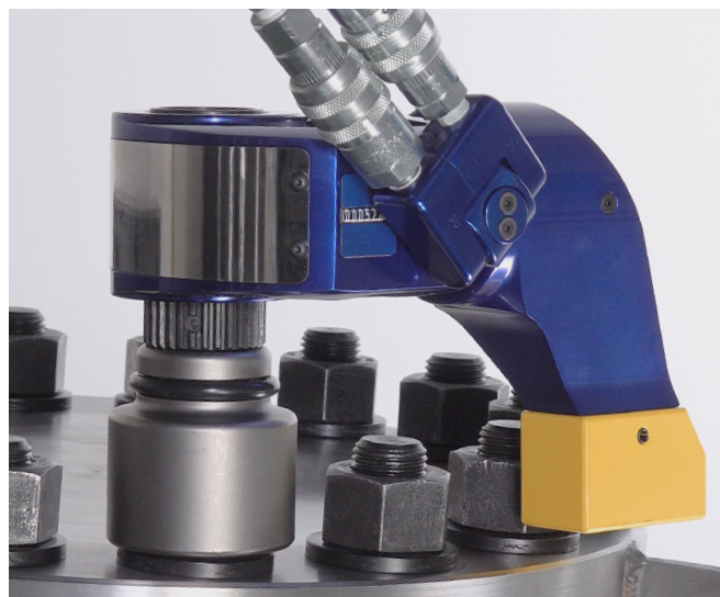
Boulonnage avec Bras de Réaction à Cannelures Arrière
