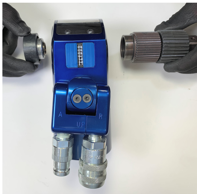
Configuration de l'Outil pour le Déserrage
